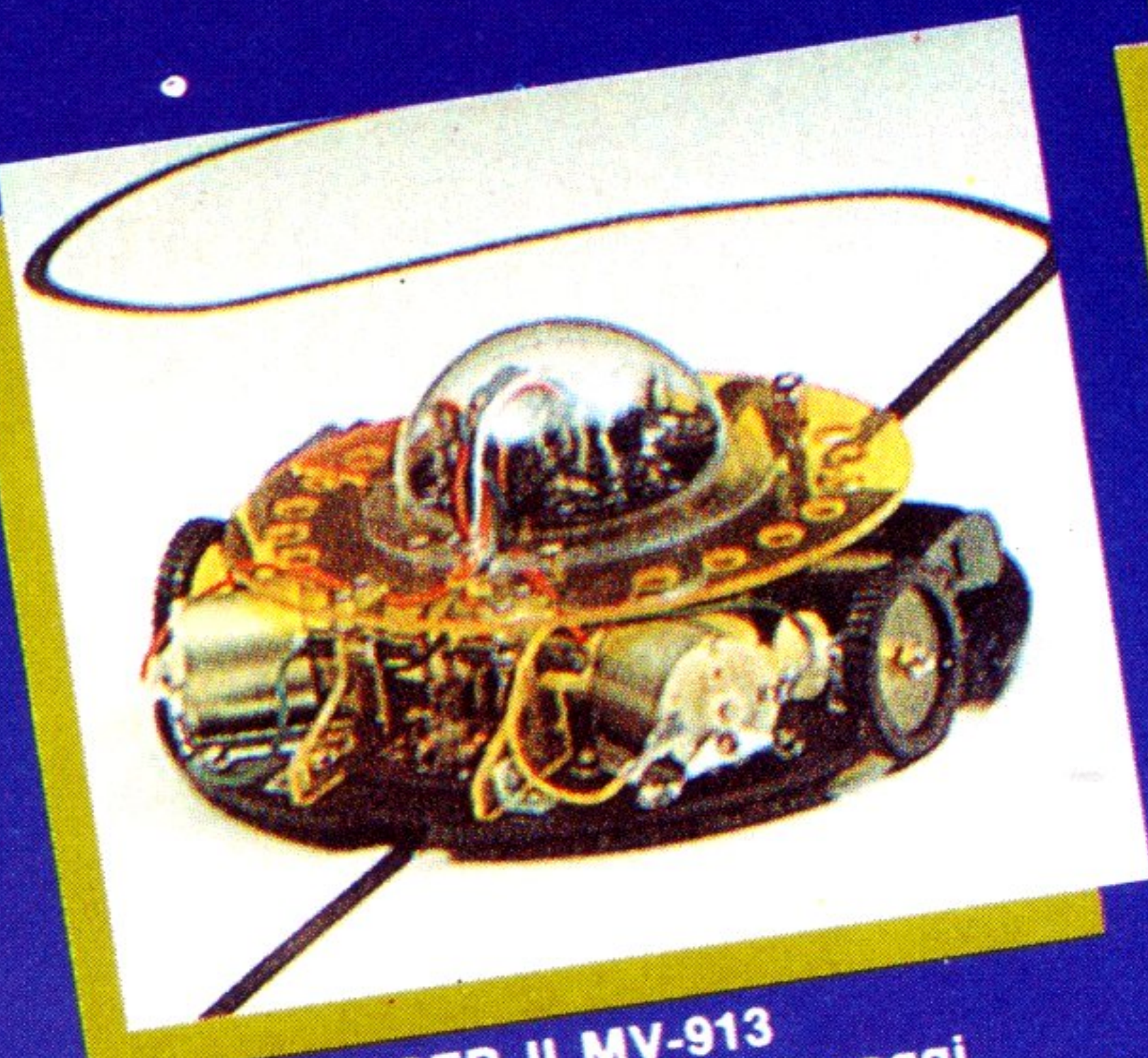
PIPER MOUSE MV-915 Usando un fischietto unito al kit PIPER MOUSE eseguirà immediatamente i comandi comunicativi: sinistra, stop, destra, stop, avanti e stop.
